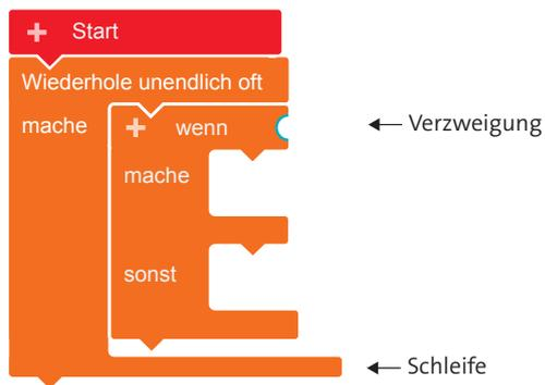
3 Der Schwellenwert muss geprüft werden, um zwischen „hell“ und „dunkel“ zu unterscheiden:
