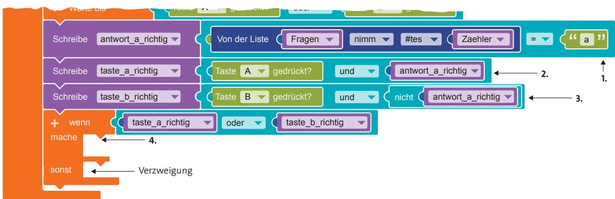
5 Es erfolgt nun eine zur richtigen und zur falschen Antwort passende Ausgabe in Form eines Bildes: Wenn der Vergleich der Tasteneingabe mit der richtigen Antwort übereinstimmt, kann nun innerhalb der Verzweigung hinter „mache“ über die Kategorie **Aktion ▶ Anzeige** und den Block „Zeige Bild“ z. B. ein Haken eingefügt werden. Hinter „sonst“, wenn eine nicht zur richtigen Antwort passende Taste gedrückt wurde, wird entsprechend ein Bild für den **LED-Bildschirm** mit z. B. einem „X“ eingefügt.
