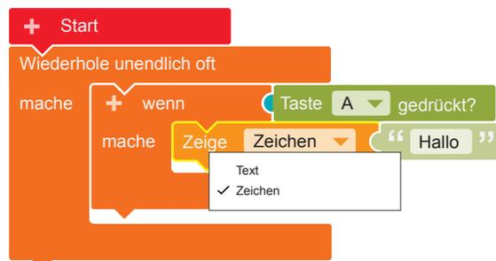
5 Im letzten Schritt muss der Wert der **Zufallszahl** festgelegt werden: Ersetzen Sie den am Block „Zeige Zeichen“ hängenden Text „Hallo“ durch den Block „ganzzahliger Zufallswert zwischen 1 bis 100“ aus der Kategorie **Mathematik**. Ersetzen Sie den Wert 100 durch die Zahl 6 (sechsfächiger Würfel), indem Sie auf die 100 klicken und über die Tastatur die Zahl 6 eingeben.
