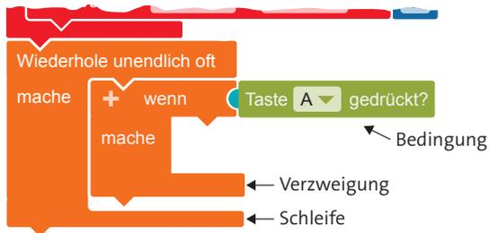
**Verzweigung** ein, mit der geprüft wird, ob der Benutzer gerade die Taste A drückt. Wählen Sie aus den Kategorien **Kontrolle** und **Sensoren** die entsprechenden Blöcke aus.
