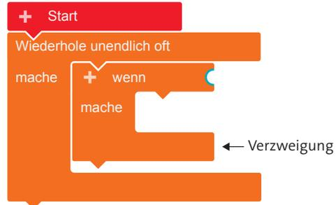
3 Die gewünschte **Eingabemöglichkeit** (hier über den **Sensor** „Taste A“) wird ausgewählt: Wählen Sie aus der Kategorie **Sensoren** den Block „Taste A gedrückt?“ und fügen Sie ihn als **Bedingung** (blauer Bereich) an die Verzweigung an.
