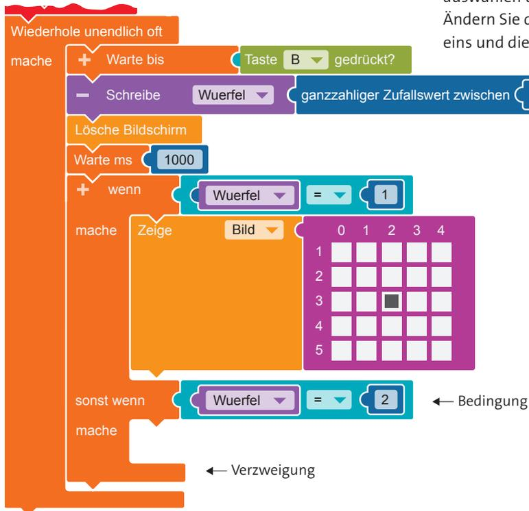
Eine weitere Verzweigung erscheint. Kopieren Sie nun den kompletten **Logik**-Block aus Schritt 10, indem sie mit der rechten Maustaste auf den zu kopierenden Block klicken und „kopieren“ auswählen und hängen Sie ihn an die Verzweigung an. Ändern Sie den Zahlenwert auf 2 durch Klicken auf die eins und die Eingabe über die Tastatur.
