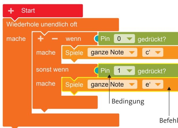
**3** Erweitern Sie das Programm so, dass alle vier Touch-Pins überprüft und vier verschiedene Töne ausgegeben werden können.
