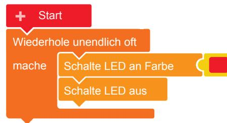
**4** Damit das An- und Ausschalten sichtbar wird, müssen **Wartezeiten** bestimmt werden, die festlegen, wie lange die RGB-LED leuchtet bzw. ausgeschaltet ist:
