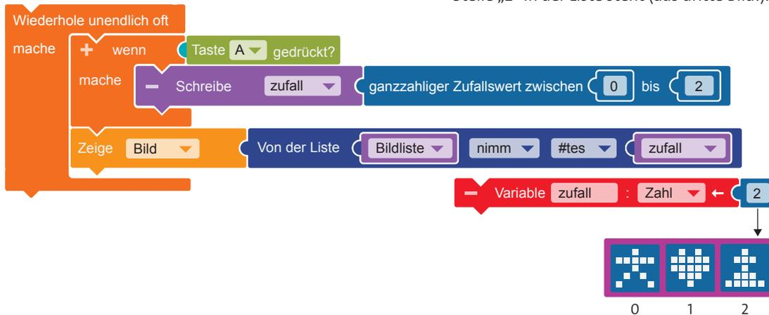
Variable *zufall* und fügen diese in die Lücke nach „#tes“ ein. Hierdurch wird das Bild ausgewählt, das an der Stelle in der Liste steht, deren Nummer dem Wert der Variablen *zufall* entspricht. Hat die Variable bspw. den Wert „2“, so wird das Bild ausgewählt, das an der Stelle „2“ in der Liste steht (das dritte Bild!).
